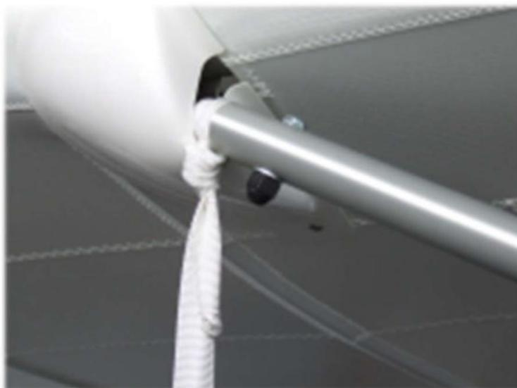
*Abbildung 4: oberer Befestigungspunkt an vorderer Flächenstrebe*
