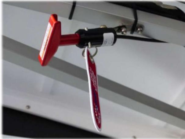
Abbildung 7: Auslösegriff mit Sicherheitspin
