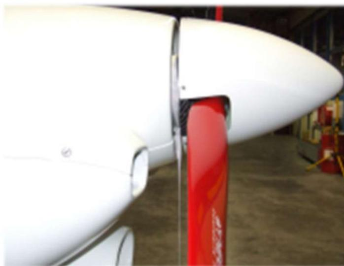
*Abbildung 5: Befestigungspunkt zwischen Cowling und Propellerspinner*
